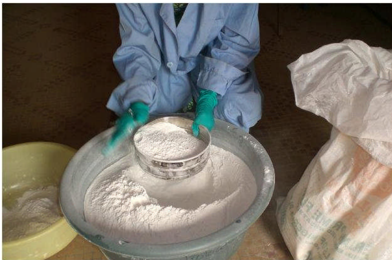
Figure 13: Tamisage de la farine de manioc
