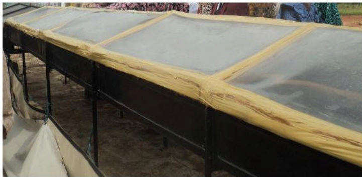
Figure 10: Séchoir Geho pour le séchage de la râpure de manioc :
