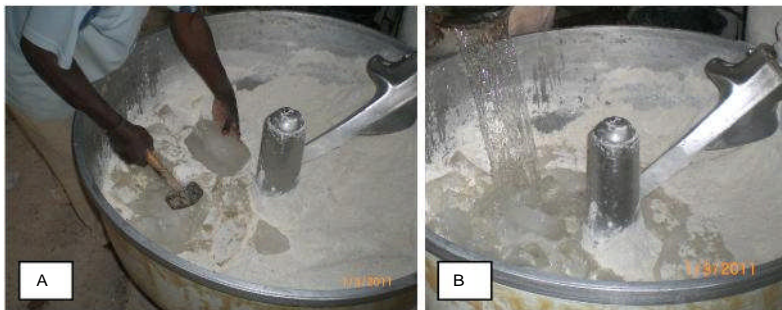
Figure 19: Ajout de la glace (A) et de l'eau (B) aux farines et ingrédients
