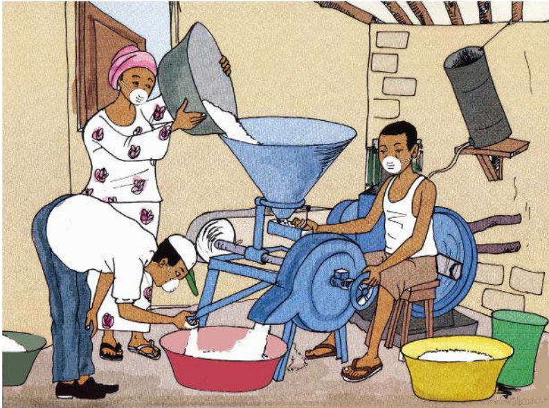
Figure 12: Mouture de la râpüre sèche de manioc
